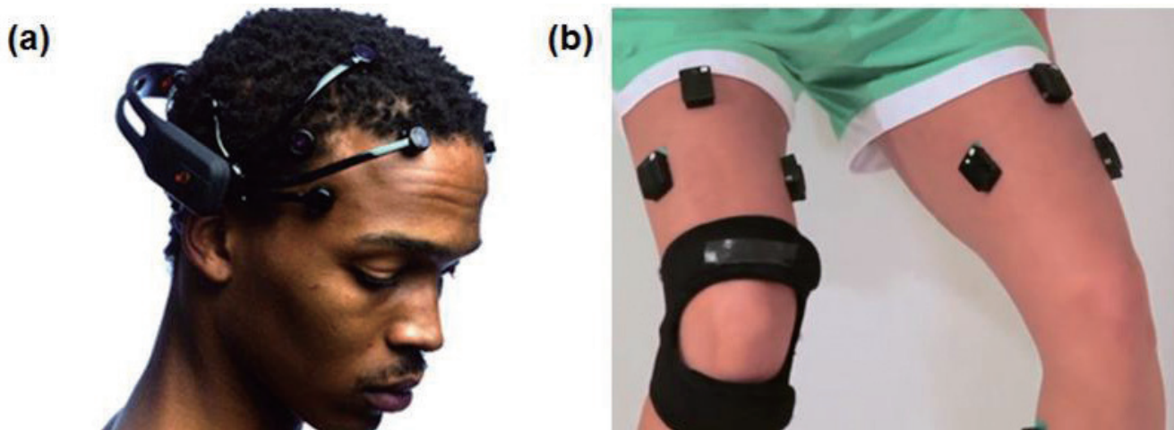
그림 3. 뇌파 전위(EEG)와 근전도(EMG) 센서들. (a) Emotiv사의 EPOC이라는 제품으로 뇌파 전위를 14개의 채널로 감지한다. (b) DELSYS사의 Trigno라는 제품으로 근육의 근복(muscle belly)에 가까운 피부에 붙이면 그 근육의 근전도를 감지한다.
